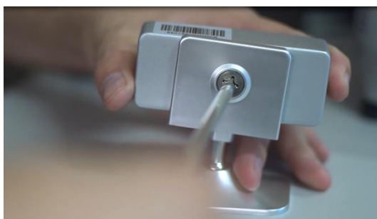
(1) Parafuse o sensor no suporte
